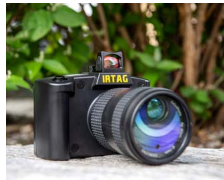
Christophe Bruchez a dessiné puis créé cet appareil à marqueur infrarouge avec une imprimante 3D, avant d'en assembler tous les composants.
